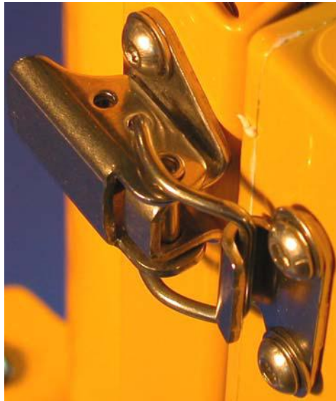
图 3 – 将读值器固定在托架上的夹钳
