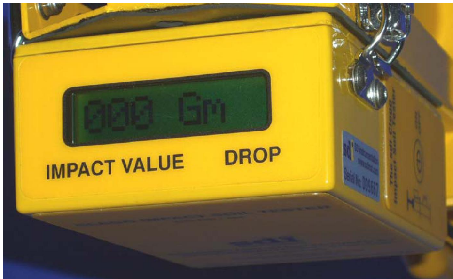
图 4 – CIST/883 数字读值器被紧紧夹在导管托架上
